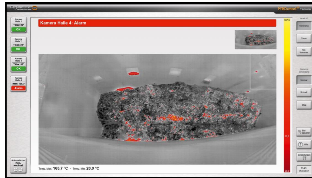
Panoramatický IR obraz zásobníku s průmyslovým odpadem a provozní panel s dotykovou obrazovkou
